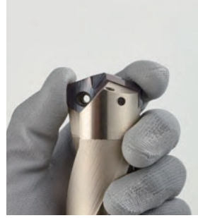
③ Takma ucu vidalarken döndürmesini engellemek için hafifçe bastırın.
