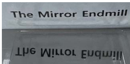
» 100min 가공 후 Ra(\mu\text{m}) = 0.03
