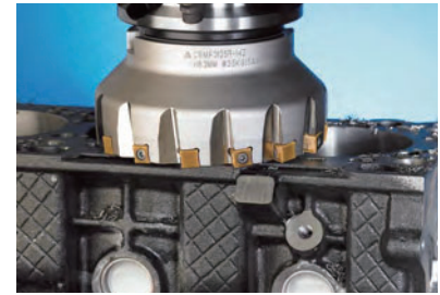
Desbaste en Fundición
